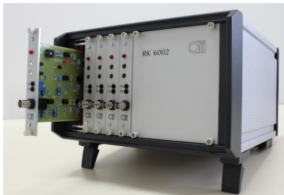
Rack accéléromètre développé par All
